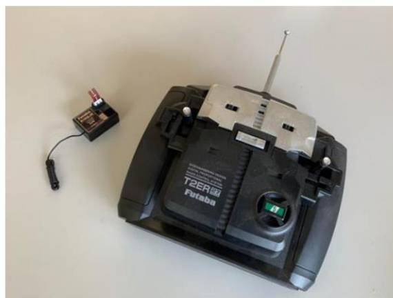
市售 3 通道 27MHz 板型遙控收發器
